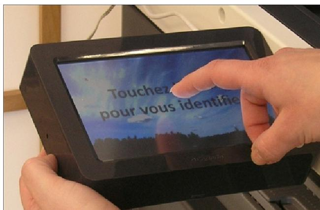
El terminal de red **cPad** conectado a una impresora o MFP (equipo multifunción), proporciona un control de acceso e identificación por medio de tarjetas MIFARE (opcional) o por login.
